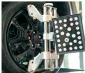
Grâce à leur conception auto centrée, les griffes de fixation 4 points assurent un serrage solide et rapide, même sur les roues disposant d'enjoliveurs.
